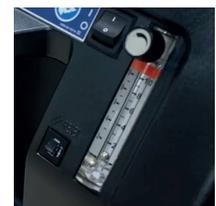
Medidor de flujo de 10 litros mediante perilla con capacidad de bloqueo.
